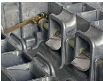
Uno sguardo all'interno di un collettore di aspirazione a geometria variabile
