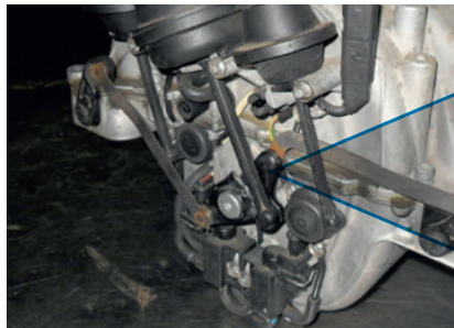
Schadensbild: Bruch am Schaltgestänge
