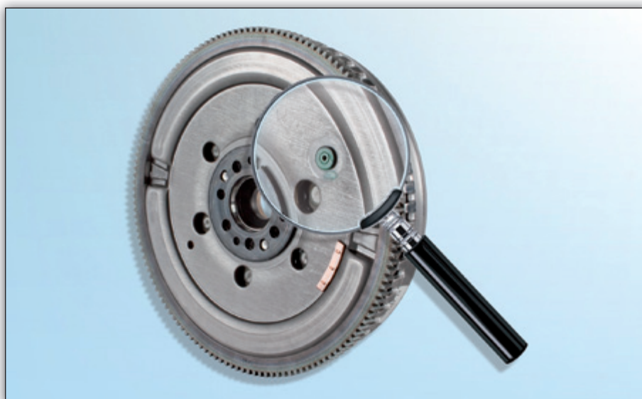
Fig. 1: O dispositivo de segurança de transporte permanece no volante motor bimatassa
