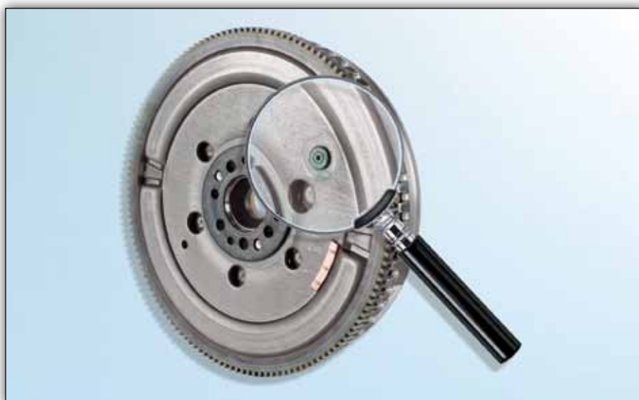
Bild 1: 415 0142 10 – Transportsäkring stannar kvar i DMS
