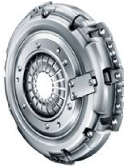
Kuva 2: Modifioitu itsesäätyvä luiskaton säätäjousilla varustettu painelevy
