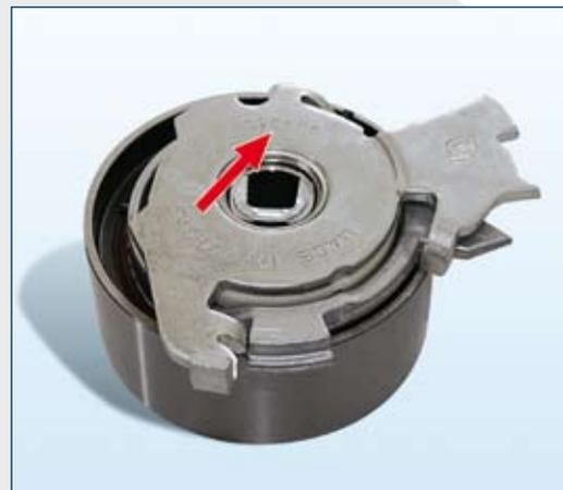
Los rodillos tensores se pueden distinguir por el número del fabricante, estampado en el lado posterior (flecha roja).
