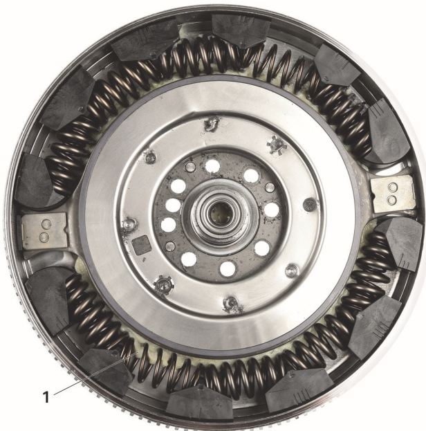
Fig. 1: Fett am Innendurchmesser des ZMS/ Grease on the inside diameter of the DMF/ Graisse sur le diamètre intérieur du volant bimasse/Grasa en el diámetro interior del DMF
