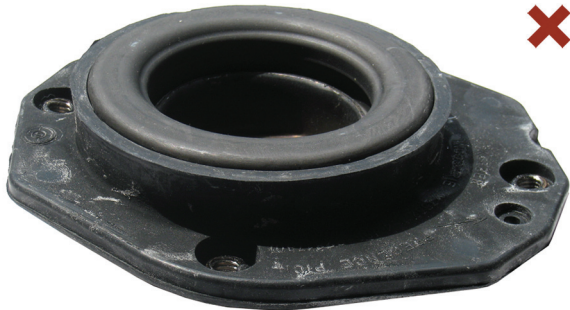
Fig. 1: Federbeinstützlager falsch montiert
