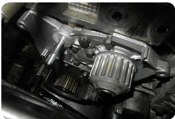
*Bomba de agua montada con par de apriete de los pernos*
