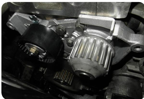
*Tensor fijado en el perno*
