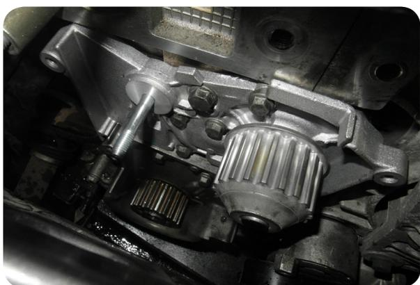
*Pompa dell'acqua montata con perno di serraggio*
