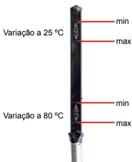
Depois de mudar o óleo da caixa automática ou se suspeitar de fugas, deverá verificar o nível do óleo. Estas caixas de velocidades não incluem vareta de verificação do nível, por padrão de fábrica.
