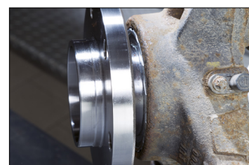
Fig. 3: Inelul de blocare trebuie să fie la același nivel cu fuzeta de direcție
