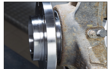
Снимка 3: Заключващия пръстен трябва да лежи наравно с шенкела.
