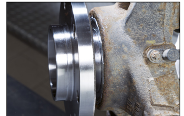
Kuva 3: Lukitusrenkaan täytyy olla olka-akselin tasolla
