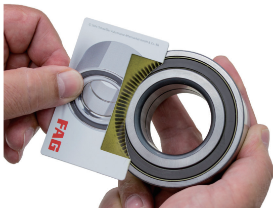
図 1：エンコーダカードの使用による、多極エンコーダの取り付け側の確認。受動エンコーダではこの方法は使用できません。
