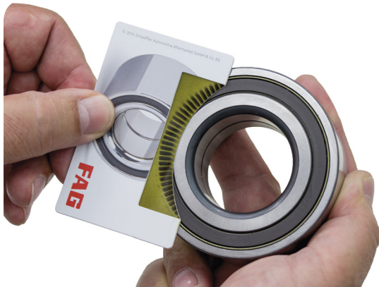
Εικόνα 1: Η κάρτα κωδικοποιητή μπορεί να χρησιμοποιηθεί για τον καθορισμό της πλευράς τοποθέτησης ενός πολυπολικού κωδικοποιητή. Αυτό δεν είναι εφικτό με παθητικούς κωδικοποιητές.
