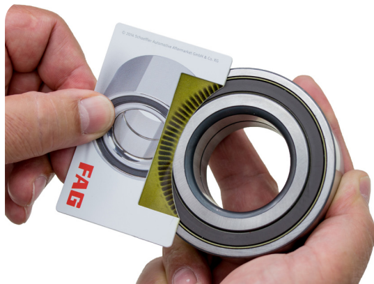
Photo 1: La carte de détection permet de détecter l'emplacement de l'encodeur multipolaire mais ne fonctionne pas pour les encodeurs passifs.
