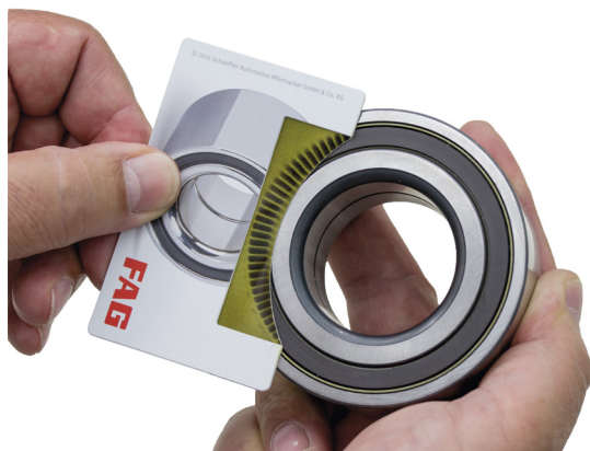
1. ábra: A kódoló-kártyával lehet egy több pólusú kódoló beszerelési oldalát megállapítani. Passzív kódolónál ez nem működik.
