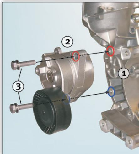
**Fig. 4:** Posición de montaje del brazo tensor mecánico
