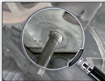
Figur 1: Skruen er ikke skrudd inn riktig.
