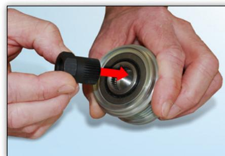
Fig. 3: Colocación del adaptador correspondiente en la polea libre.
