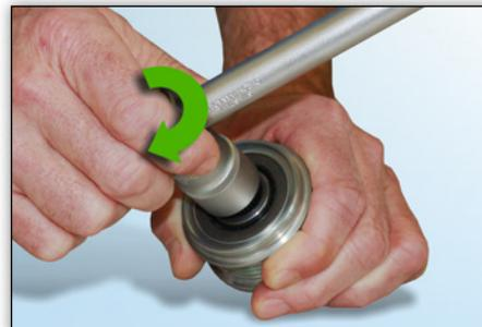
**Fig. 5:** En sentido horario, la herramienta se puede girar con una ligera resistencia ininterrumpidamente.
