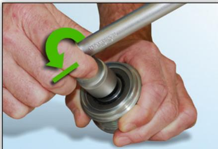
**Fig. 4:** Al girar en sentido antihorario, se bloquea la herramienta y no se puede girar.
