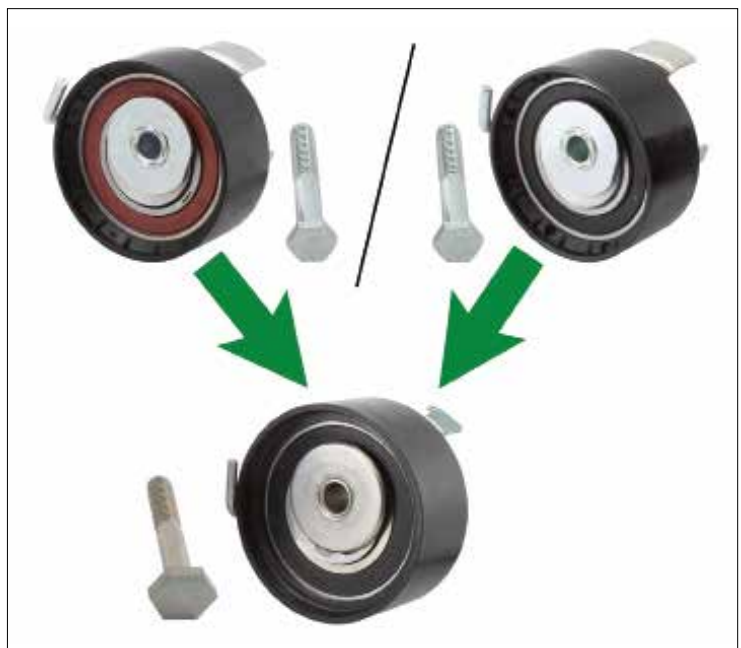
Фигура 1: Горния: двете предходни версии с червен и черен уплътнител. Долния: Новия модел
