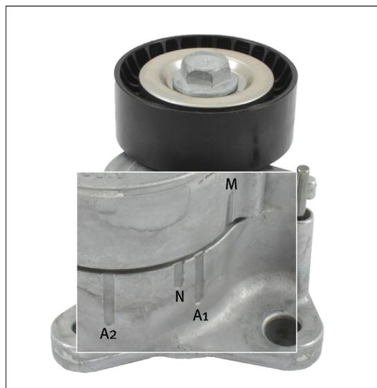
Рисунок 2: Улучшенные указатели рабочего диапазона натяжной планки.
