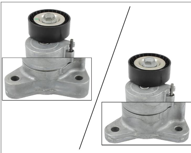
Рисунок 3: Слева, прежняя версия с широким местом крепления.
