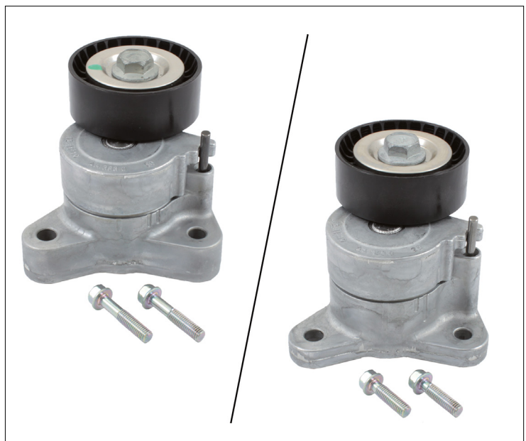
Obrázok 1: Napínacie rameno 534 0325 10 – vľavo, staré vyhotovenie s upevňovacími skrutkami Vpravo, nové vyhotovenie s upevňovacími skrutkami
