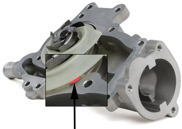
Fig. 2: Disco de plástico suelto debido al exceso de sellador
